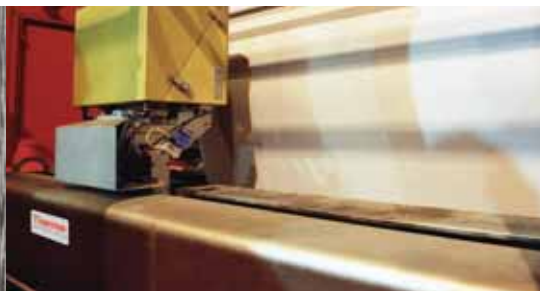
RM 300 EC Messung des Schichtdicke
