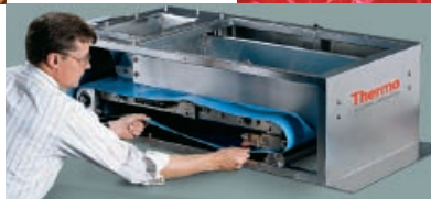
Telaio autoportante con possibilità di estrazione laterale del nastro per garantire la facile rimozione del tappeto
