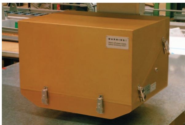
Cabeza de medición por fluorescencia de rayos X para una cara de la lámina recubierta
