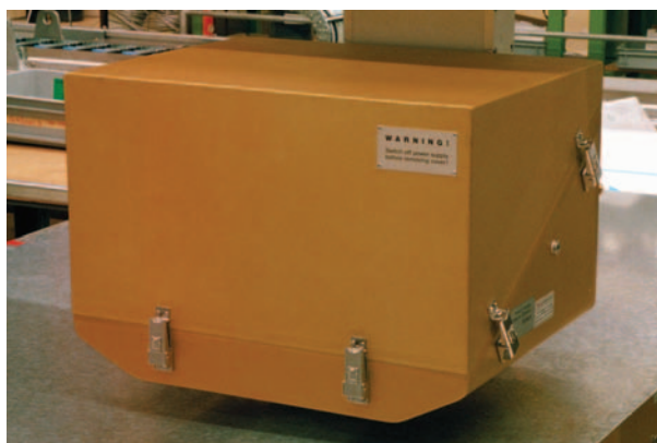
Tête de Mesure en Fluorescence X Pour un Côté de la Bande Revêtue
