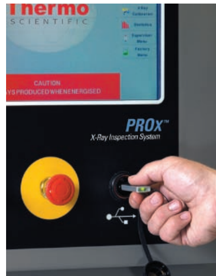
Overbrengen van gegevens naar een pc via de ingebouwde, waterdichte USB-aansluiting
