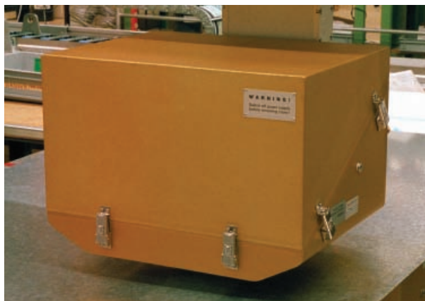
Рентгеновская флуоресцентная измерительная головка для одной стороны полосы с покрытием
