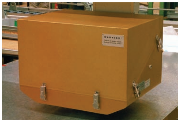
Рентгеновская флуоресцентная измерительная головка для одной стороны полосы с покрытием
