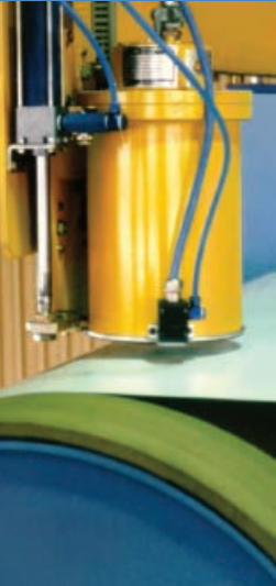
El calibre de peso de recubrimiento RM 300 EL utiliza cabezales de medición de reflexión de radiación beta
