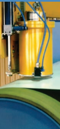
Толщиномер покрытий RM 300 EL, использующий измерительные головки обратного рассеяния бета-излучения
