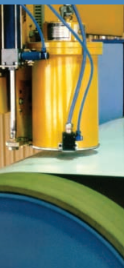
Jauge de poids RM 300 EL pour revêtement avec têtes de mesure à rétrodiffusion bêta
