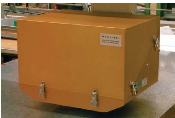
めっき鋼板の片側蛍光X線測定ヘッド
