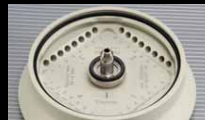
▶ Rotore PCR 4 x 8 con coperchio a biocontenimento ClickSeal
