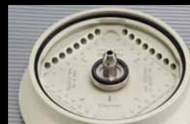
► Rotor PCR 4 x 8 con tapa de biocontención ClickSeal
