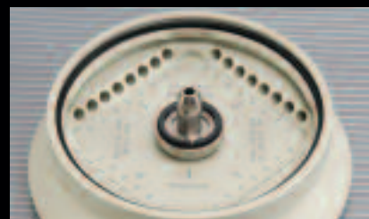
▶ Rotore PCR 4 x 8 con coperchio a biocontenimento ClickSeal
