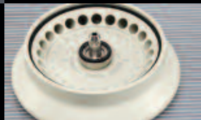
▶ Rotore 24 x 1,5/2,0 ml con coperchio a biocontenimento ClickSeal
