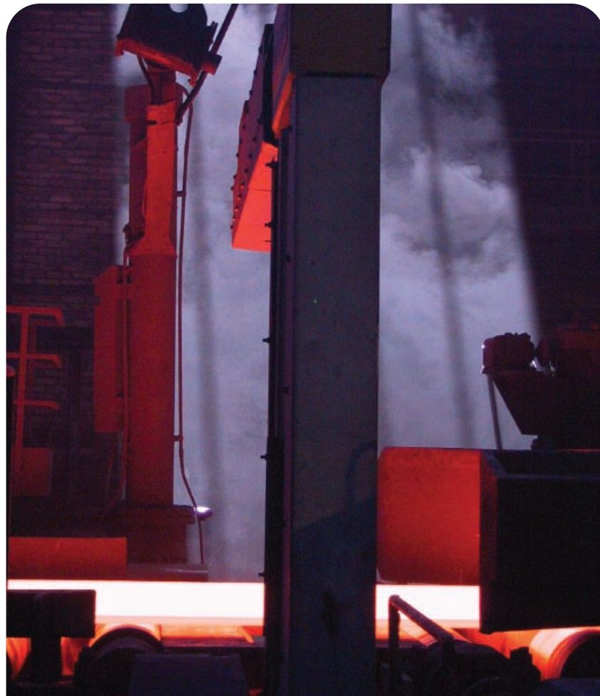
Dickenmesssystem Thermo Scientific RM 200 EG in einem Grobblechgerüst
